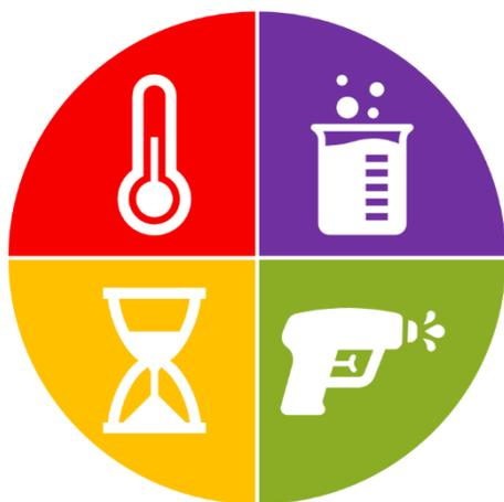
Le cercle de Sinner est une théorie de nettoyage qui définit les quatre facteurs (TACT) permettant d'atteindre un nettoyage efficace : la température, l'action mécanique, l'action chimique et le temps de nettoyage.
